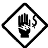
電流容量の少ない電線を使用すると、絶縁被膜が熔け絶縁不良となり感電・漏電の恐れがある他、火災の原因になることがあります。
