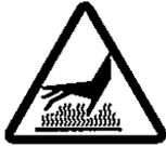
通電だけでもコイルの発熱によって、本体の表面温度は上昇し、触ると火傷をすることがありますのでご注意ください。
