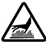
製品の表面温度は、スリップ熱・内蔵コイルの発熱により、約90℃～100℃前後に上昇することがあります。手を触れると火傷をしますので、運転中の製品には決して手や指などを触れないでください。また、運転停止後もすぐには温度は下がりません。
